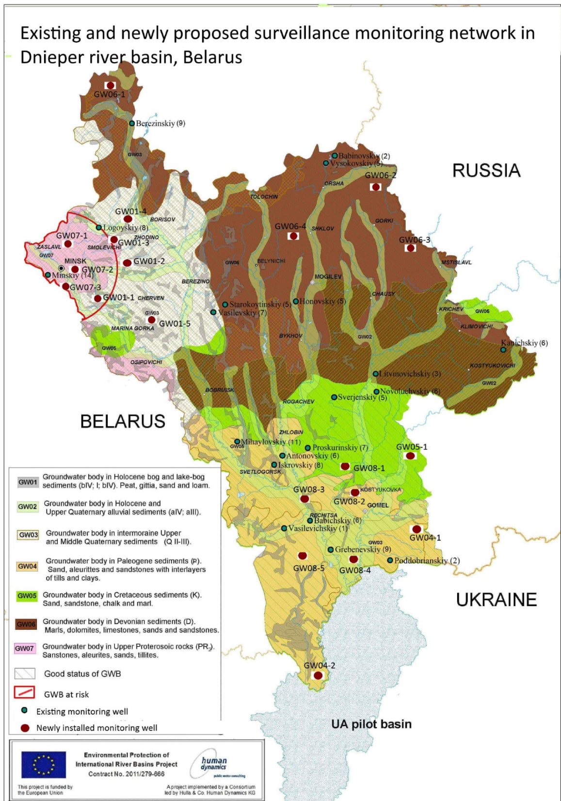
Рисунок 6.20 – Существующая и рекомендуемая сеть наблюдательного мониторинга подземных вод (количественного и химического)
