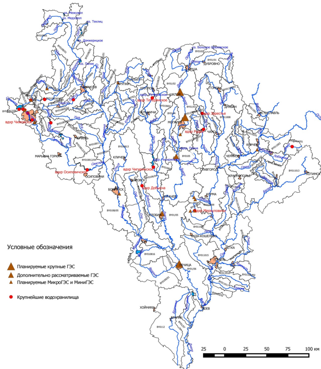
Рисунок 3.7 – Схема расположения русловых водохранилищ, оказывающих влияние на водный режим рек
